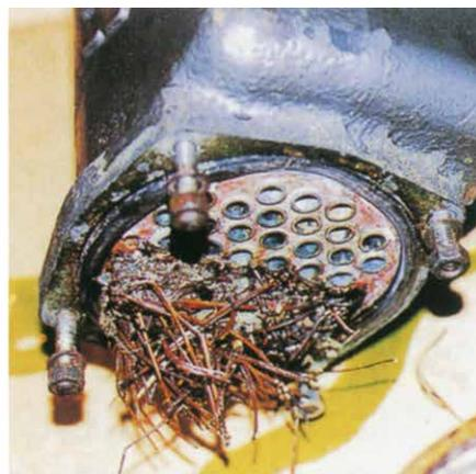
※最近のエンジンは、この部分の掃除が難しい構造になっている型式のものが多いので、掃除が簡単なもの以外は整備業者に依頼してゴミを取り除いて下さい。
