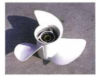
破損したプロペラ → つり糸の巻き付いたプロペラシャフト
